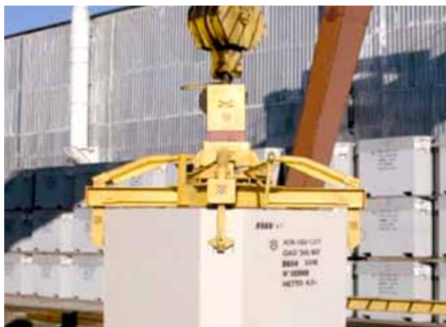
Бетонный контейнер для наземного хранения РАО
