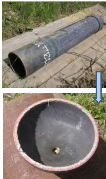
Резка газового баллона
