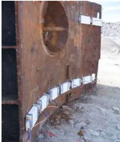
основные заряды размещенные на «прочном» корпусе (суммарная МВВ=12,6 кг ТЭ)
