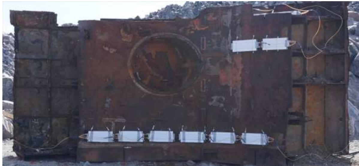
основные заряды размещенные на «прочном» корпусе (суммарная МВВ=12,6 кг ТЭ)
